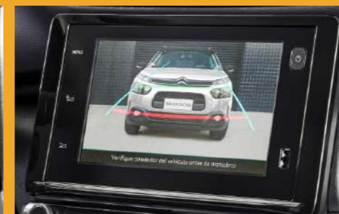
Cámara de retroceso
