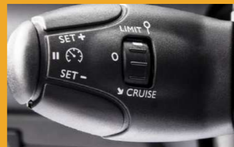
Limitador y regulador de velocidad
